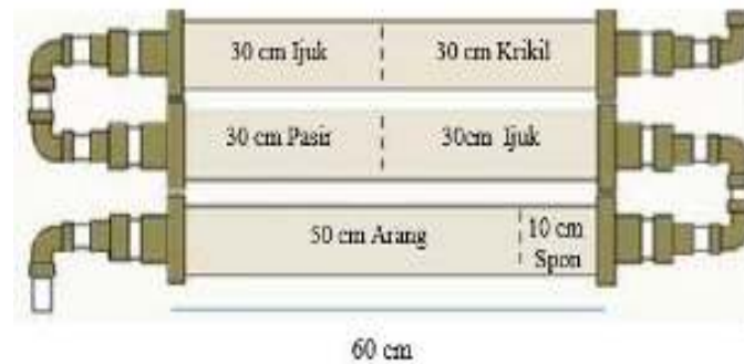
Gambar 4. Pipa Penyaring Bersusun
