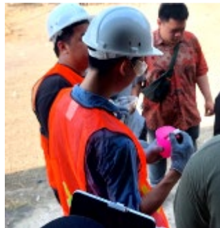
Gambar 5. Pengukuran Jumlah Partikel Terlarut Dalam Air Hasil ALPAMAL dengan TDS Meter
