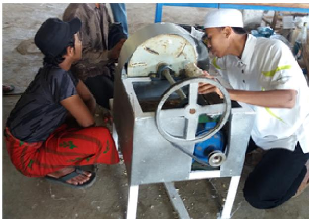
**Gambar 4.** Alat pemotong tempe
