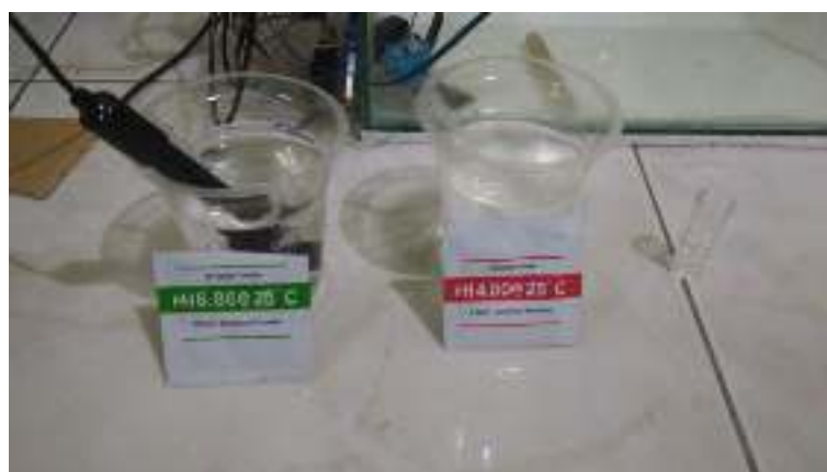
Gambar 8. Pengujian Sensor PH
