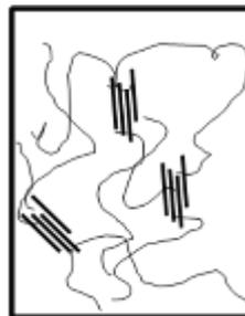
Gambar 2. *Higher-order Structure* dari poliuretan tersegmentasi (Satoshi, 2018).
