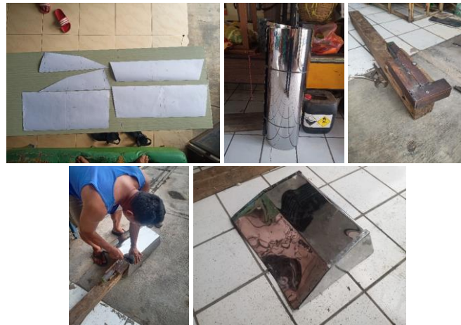
Gambar 9. Tahapan pembuatan sudu ( blade )
