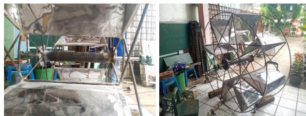
Gambar 14. Hasil akhir proses assembly komponen-komponen kincir air
