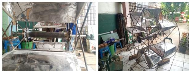
**Gambar 14.** Hasil akhir proses *assembly* komponen-komponen kincir air
