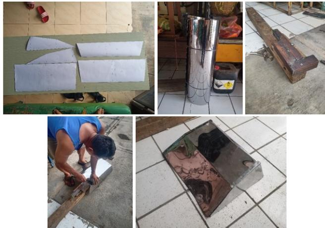
**Gambar 9.** Tahapan pembuatan sudu (*blade*)
