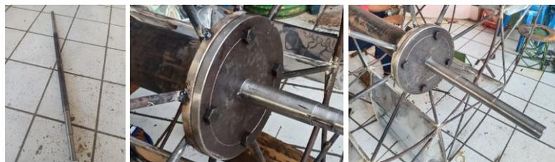
**Gambar 13.** Pemasangan *inner flange*, poros bertingkat, dan pasak pada *outer flange*
