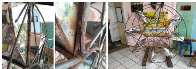
**Gambar 10.** Tahapan pemasangan sudu (*blade*)
