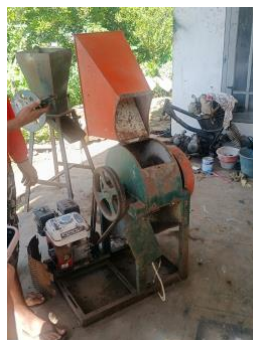
Gambar 1. Mesin pencacah limbah organik milik warga Desa Kukur yang digunakan dalam proses reduksi material sampah.
