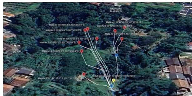
Gambar 1. Peta alur pemipaan dari sumber mata air ke bak penampung
